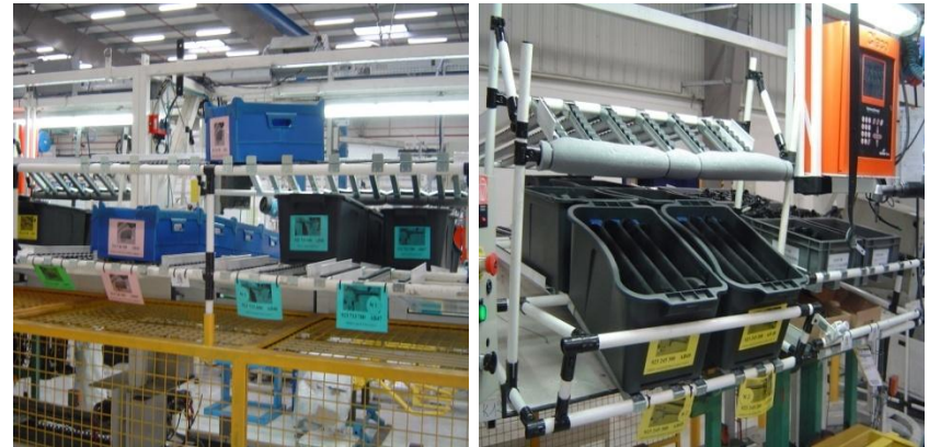
Réfection des bords de ligne en passant en petits conditionnements recyclables
